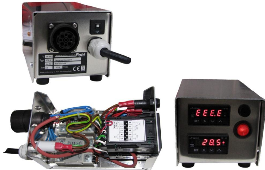
Gesamtansicht Regler RT5-2
